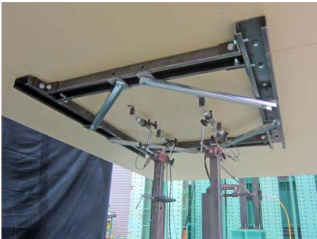
写真 4 試験実施状況（加力治具と変位計の設置状況）
