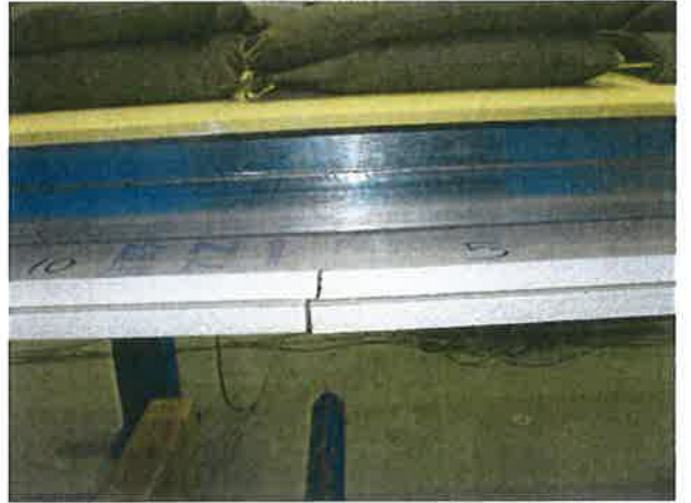
写真2 試験体の状況（所定荷重時） ・下面材下張せっこうボードの割れ
