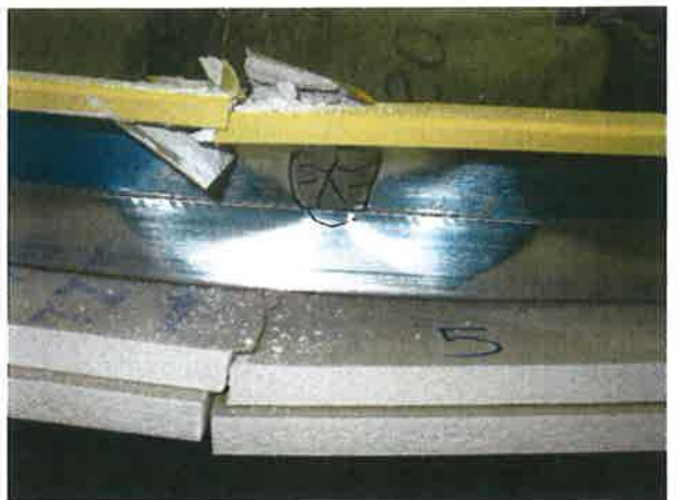
写真6 試験体の状況（最大荷重時） 最大荷重= 3394 N/m 2 ・スタッドの曲げ破壊
