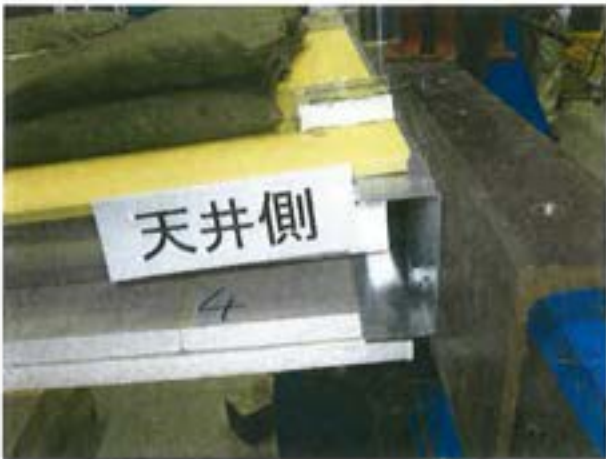
写真3 試験体の状況（所定荷重時） ・支持部の状況
