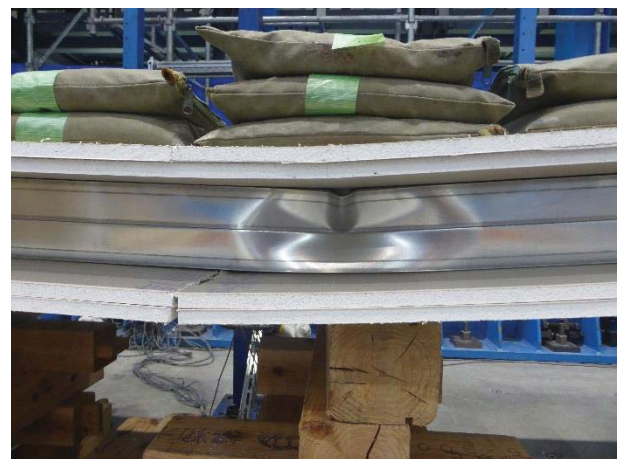
写真 6 試験体の状況（破壊後） 最大荷重：2828 N/m 2 ・スタッドの曲げ変形
