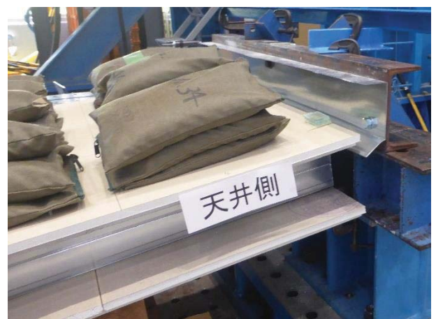
写真 6 試験体の状況（破壊後） 最大荷重：2984 N/m 2 ・天井側ランナの開きによるスタッドの脱落
