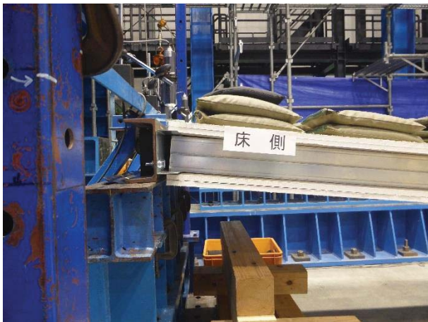
写真 3 試験体の状況（所定荷重時） ・支持部
