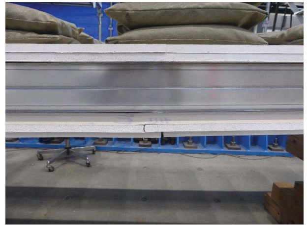
写真 2 試験体の状況（所定荷重時） ・下面材下張せっこうボードの割れ
