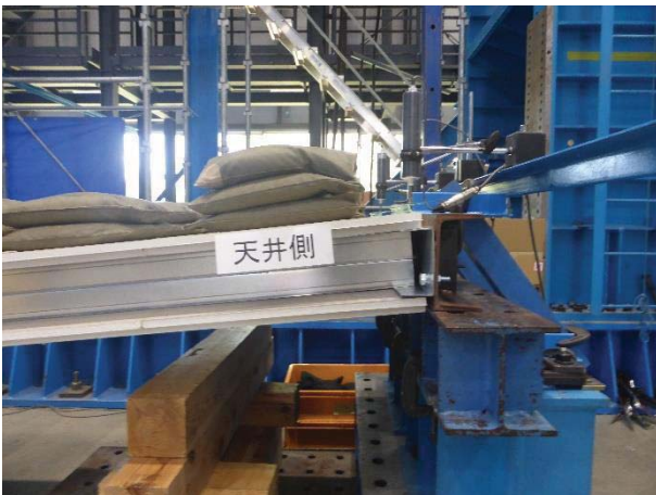
写真 3 試験体の状況（所定荷重時） ・支持部
