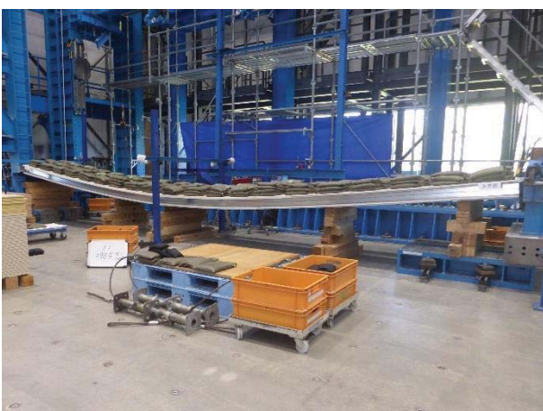
写真 5 試験体の状況（破壊後） 最大荷重：2984 N/m 2 ・全景
