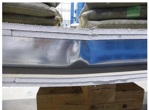
写真 6 試験体の状況（破壊後） 最大荷重：2806 N/m 2 ・スタッドの曲げ変形
