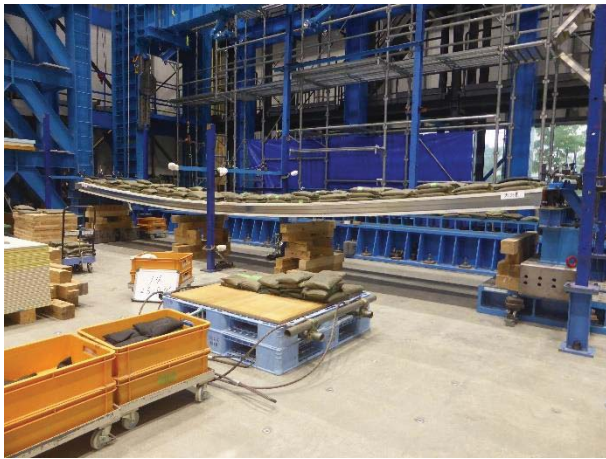
写真 1 試験体の状況（所定荷重時） ・全景
