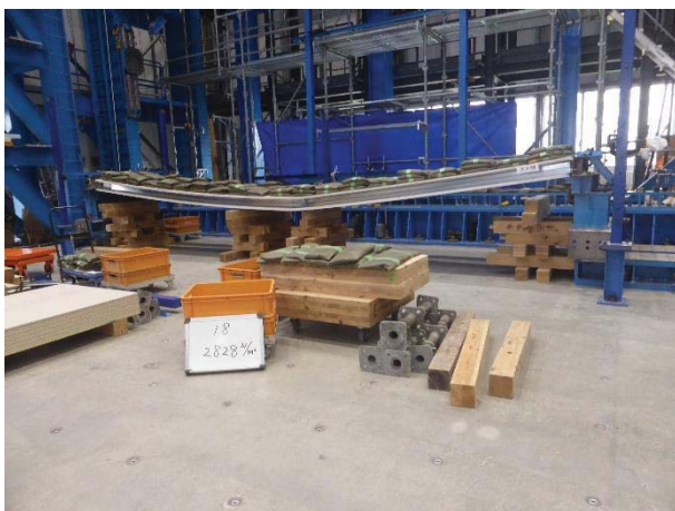
写真 5 試験体の状況（破壊後） 最大荷重：2828 N/m 2 ・全景
