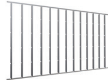
スタッドの建込み
