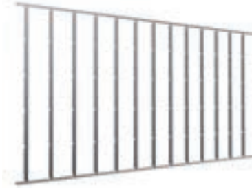
スタッドの建込み
