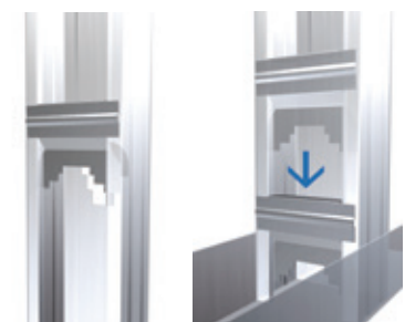
スペーサの取付
