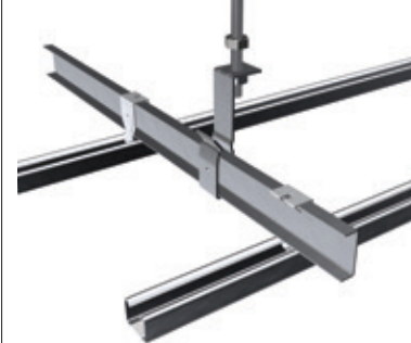
野縁の取付け3
