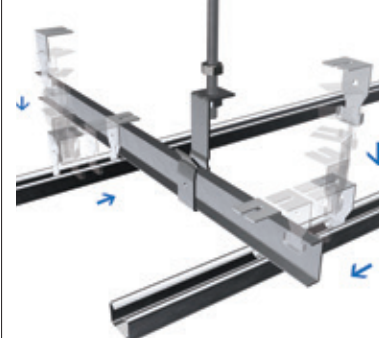
野縁の取付け 1
