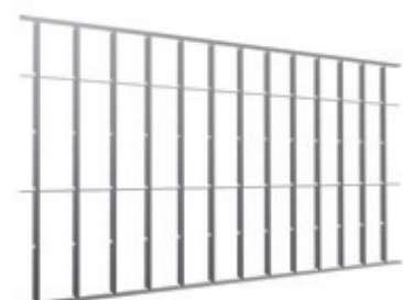
振れ止めの取付け
