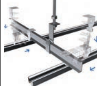
野縁の取付け 1
