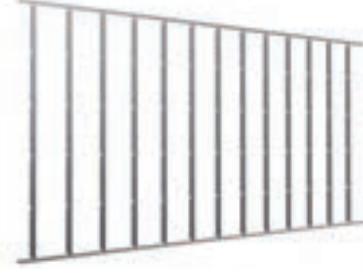
スタッドの建込み
