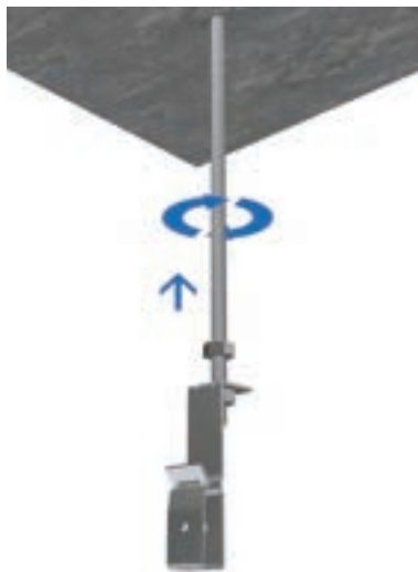
天井インサートにねじ込み
