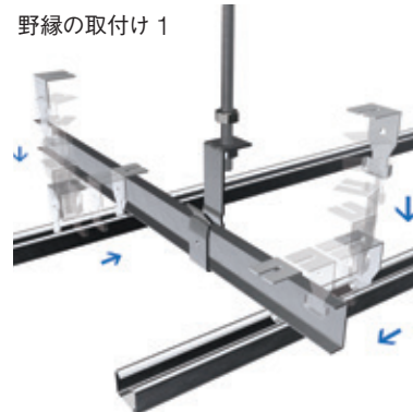
野縁の取付け 1
