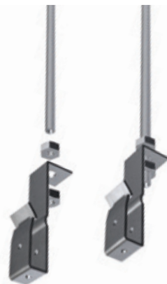
つりボルトにハンガを取付け
