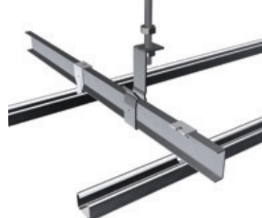
野縁の取付け3
